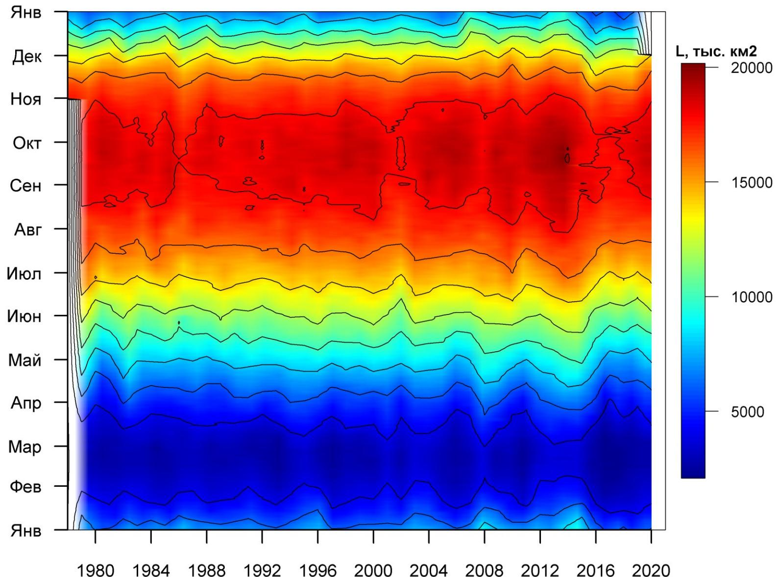
Рисунок 7б – Ежедневные оценки сезонных изменений ледовитости для Южного океана за период 26.10.1978 – 29.11.2020 на основе расчетов по данным SSMR-SSM/I-SSMIS, алгоритм NASATEAM.
