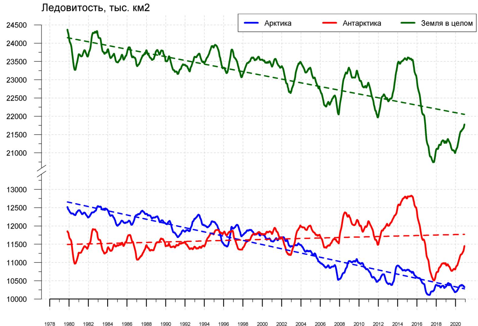
Рисунок 9 – Ежедневные сглаженные окном 365 суток значения приведенной ледовитости (площади морского льда) Арктики, Антарктики и Земли в целом с 26.10.1978 по 29.11.2020 на основе SSMR-SSM/I-SSMIS
