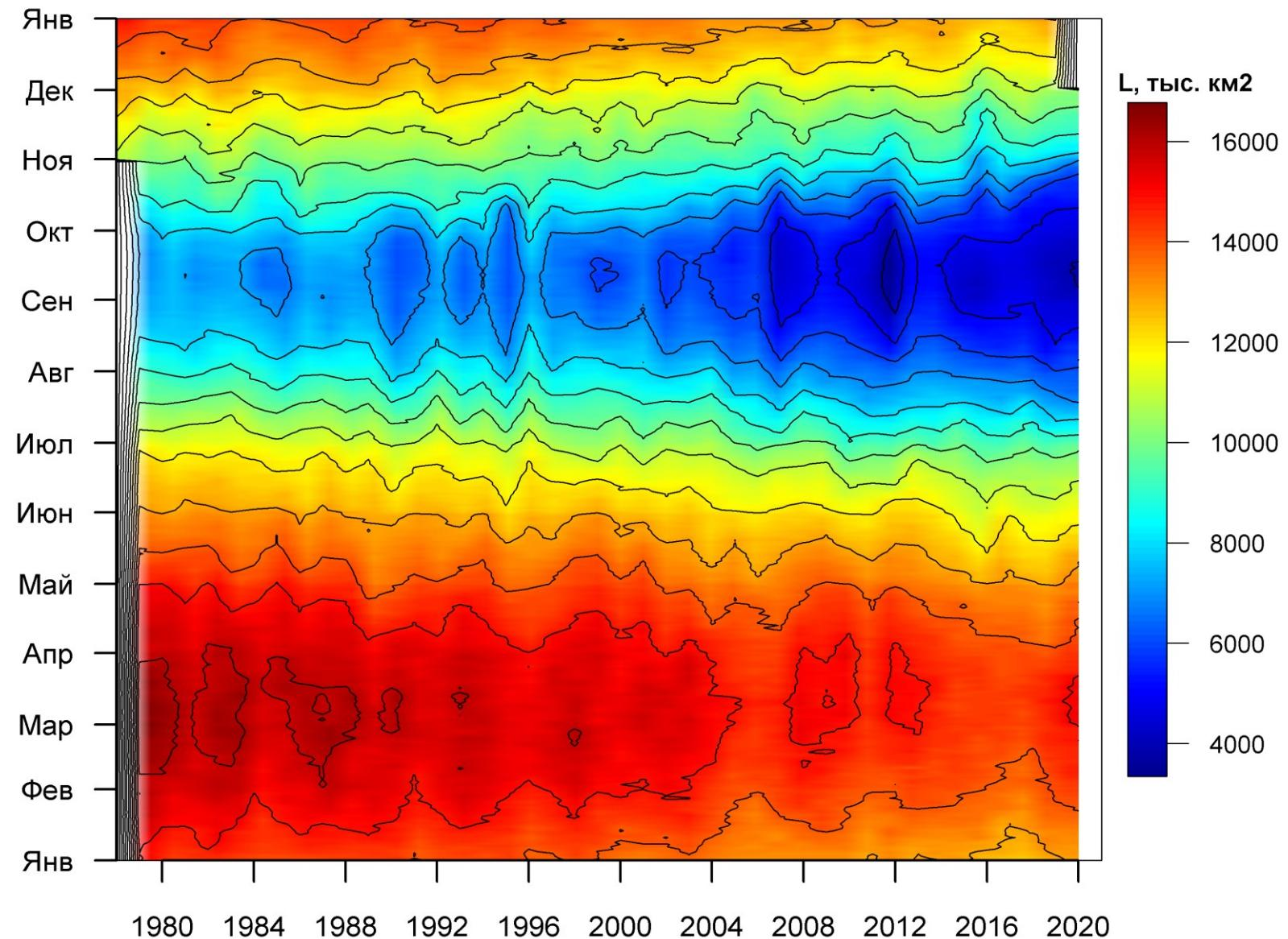
Рисунок 3б – Ежедневные оценки сезонных изменений ледовитости для Северной Полярной Области за период 26.10.1978 – 22.11.2020 на основе расчетов по данным SSMR-SSM/I-SSMIS, алгоритм NASATEAM.
